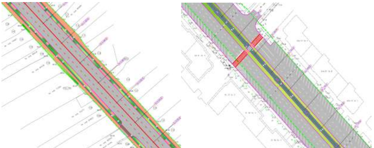
Fig – captură plan de situație propus Calea București– piste unidirectionale pe trotuar (stanga) și pista bidirecțională propusă în zona mediană a străzii (dreapta)
