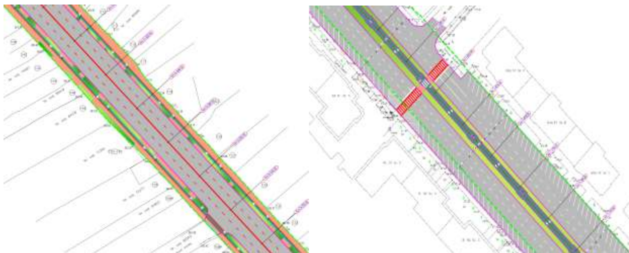
Fig – captură plan de situație propus Calea București– piste unidirectionale pe trotuar (stanga) si pista bidirectionala propusa in zona mediana a strazii (dreapta)
