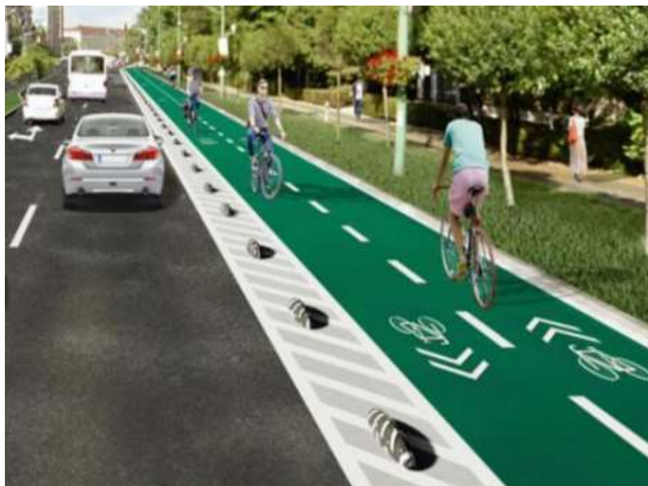
Fig – model marcaje și delimitare cu bolarzi de cauciuc a pistei de biciclete față de banda
